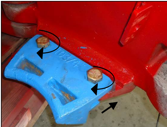
Door guide installation
