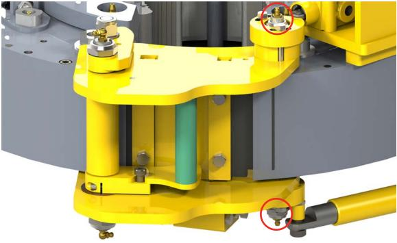
Illustration 5.5.10: Door Pivot Shaft Lubrication
